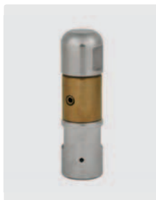
1/8" IG. Seitenstrahl 2. Rostfreier Edelstahl. Rotationskörper Hochdruckbronze. Kompakte Bauform, universell einsetzbar. Extrem hohe Reinigungsleistung, entfernt härteste Ablagerungen. 1 63 mm. Ø 12 mm. Gewicht 0,18 kg. Max. 1000 bar
