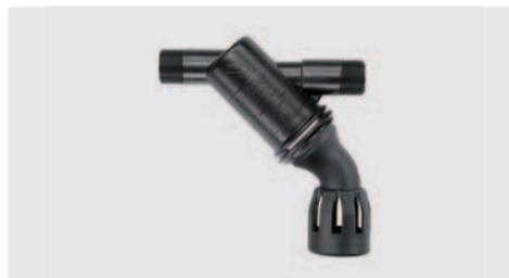
Spezielle Sicherheitseinrichtung, die gewährleistet, dass kein Wasser zurück in das öffentliche Trinkwassernetz fließt. Rückflussverhinderer nach EN 60335-2-79:2010. Max. 35 l/min. Druck min. 1 bar / max. 10 bar
