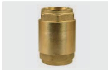
R+M Rückschlagventil. Ventilkegel aus Kunststoff mit Gummidichtung. Schließfeder Edelstahl. Verhindert Rückfluss in jeder Stellung. 20 bar
