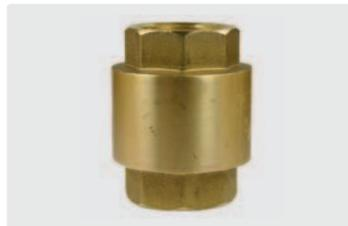
YORK Rückschlagventil. Ventilkegel aus Kunststoff mit Gummidichtung. Schließfeder Edelstahl. Verhindert Rückfluss in jeder Stellung. 12 bar
