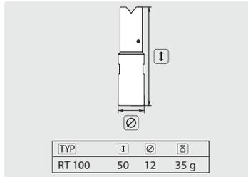
Rostfreier Edelstahl. Rotationskörper Hochdruckbronze. Kompakte Bauform, universell einsetzbar. Extrem hohe Reinigungsleistung, entfernt härteste Ablagerungen. Druck max. 1000 bar. Lieferzeit ca. 3-4 Wochen
