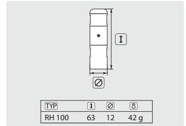
Rostfreier Edelstahl. Rotationskörper Hochdruckbronze. Kompakte Bauform, universell einsetzbar. Extrem hohe Reinigungsleistung, entfernt härteste Ablagerungen. Druck max. 1000 bar. Lieferzeit ca. 3-4 Wochen
