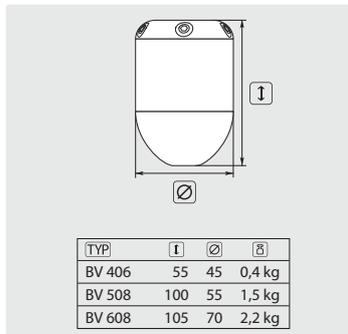
Rostfreier Edelstahl. Auswechselbare Einsätze. Höchste Zug- und Reinigungskraft. Druck max. 250 bar. Beseitigung von Ablagerung und Verstopfung, Kanalreinigung. Lieferzeit ca. 3-4 Wochen
