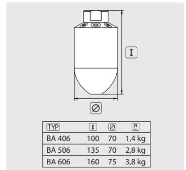
Hochverschleißfester Stahl gehärtet. Auswechselbare Einsätze. Höchste Zug- und Reinigungskraft. Druck max. 250 bar. Zur Rundumreinigung stark verschmutzter oder verstopfter Kanäle. Lieferzeit ca. 3-4 Wochen
