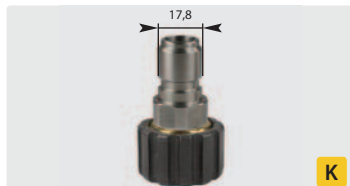
Stecknippel : IG. Edelstahl + Messing. Max. 250 bar / 150 °C
