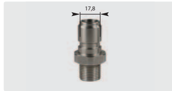
Nippel : AG. Edelstahl gehärtet. 60° Dichtkonus. Max. 250 bar / 150 °C
