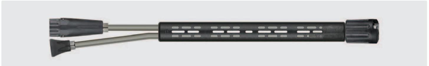
1/4" IG. Schaumdoppellanze mit Isolierung ST-9 380 mm, Umschaltventil ST-58, Düsenschutz ST-10 ohne Düse und Schaumkopf ST-75 ohne Düse. Es wird ein Schauminjektor benötigt. Max. 350 bar / 45 l/min / 100 °C
