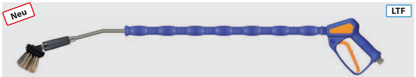
Strahlrohr mit umspritzter Isolierung Cool & Compact, easywash365+ Pistole, Luftinjektor turbofoam365+ und Waschbürste (Borsten 60 mm). 20-150 bar. Max. 50 °C
