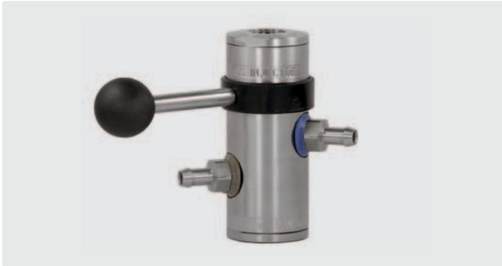
1/2" IG : 1/2" IG. Injektor mit Tülle 9 mm und Druckluftmodul (Tülle 9 mm). Regulierung der Chemiedosierung erfolgt durch 8 auswechselbare Dosiereinsätze (0,5 - 1,5 mm).
