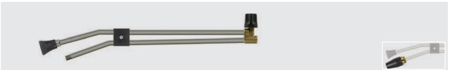
1/4" IG. Strahlrohr mit Ventil ST-53 oben und Düsenschutz ST-10 mit Niederdruckdüse & Anschluss 1/4" AG für Rotordüsen. Strahlrohr wird ohne Rotordüse geliefert. Max. 250 bar / 150 °C
