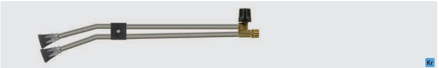
M22 AG. Strahlrohr mit Ventil ST-53 oben und Düsenschutz ST-10 mit Niederdruckdüse & Muffe 1/4" IG. Max. 250 bar / 150 °C
