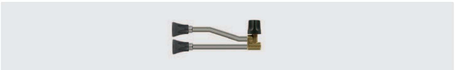
1/4" IG. Strahlrohr mit Ventil ST-53 oben und Düsenschutz ST-10 mit Niederdruckdüse & Muffe 1/4" IG. Max. 250 bar / 150 °C
