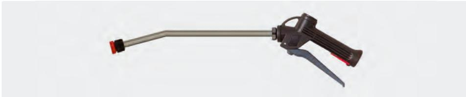
300 mm. Chemiepistole mit Lanze aus Edelstahl und Düsenhalter ohne Düse. Pistole mit chemiebeständiger Edelstahlkugel V4A / AISI 316. Dichtungen aus Viton. Max. 25 bar / 30 l/min / 50 °C
