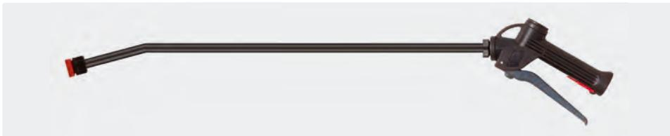
600 mm. Chemiepistole mit Lanze aus Kunststoff und Düsenhalter ohne Düse. Pistole mit chemiebeständiger Edelstahlkugel V4A / AISI 316. Dichtungen aus Viton. Max. 25 bar / 30 l/min / 50 °C
