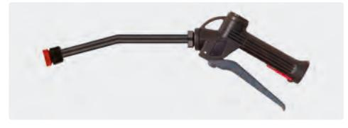
210 mm. Chemiepistole mit Lanze aus Kunststoff und Düsenhalter ohne Düse. Pistole mit chemiebeständiger Edelstahlkugel V4A / AISI 316. Vitondichtungen. Max. 25 bar / 30 l/min / 50 °C
