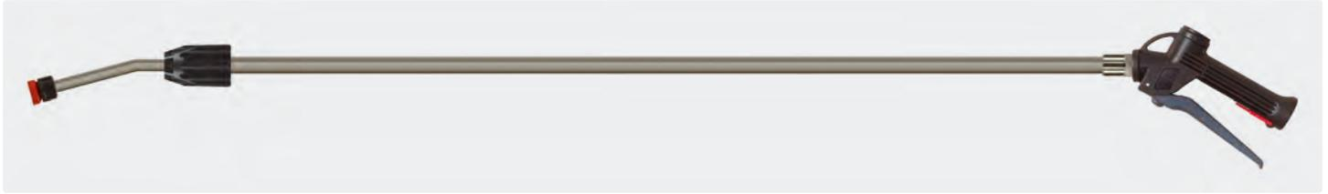
1000 - 2000 mm. Chemiepistole mit Teleskoplanze aus Edelstahl und Düsenhalter ohne Düse. Pistole mit chemiebeständiger Edelstahlkugel V4A / AISI 316. Dichtungen aus Viton. Max. 25 bar / 30 l/min / 50 °C
