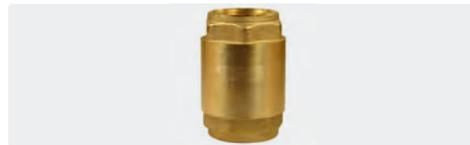
R+M Rückschlagventil. Ventilkegel aus Kunststoff mit Gummidichtung. Schließfeder Edelstahl. Verhindert Rückfluss in jeder Stellung
