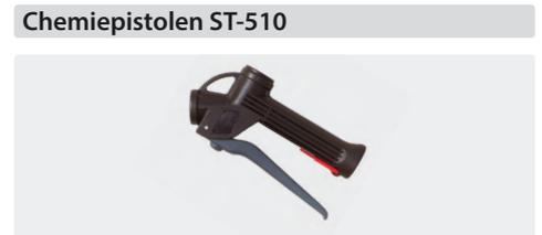
Pistole mit chemiebeständiger Edelstahlkugel V4A / AISI 316. Dichtungen aus Viton. Max. 25 bar / 70 l/min / 50 °C
