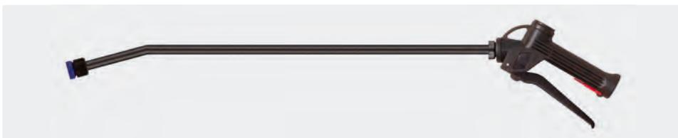
600 mm. Chemiepistole mit Lanze aus Kunststoff und Düsenhalter ohne Düse. Pistole mit säurebeständiger Kugel. Dichtungen aus Viton/EPDM. Max. 25 bar / 30 l/min / 50 °C
