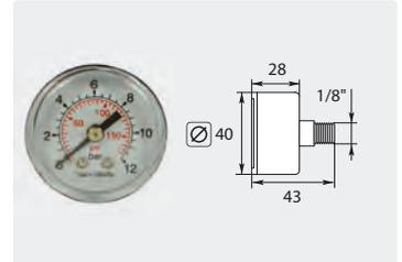
Ø 40 mm. Gehäuse Kunststoff. Eingang hinten. 1/8" AG
